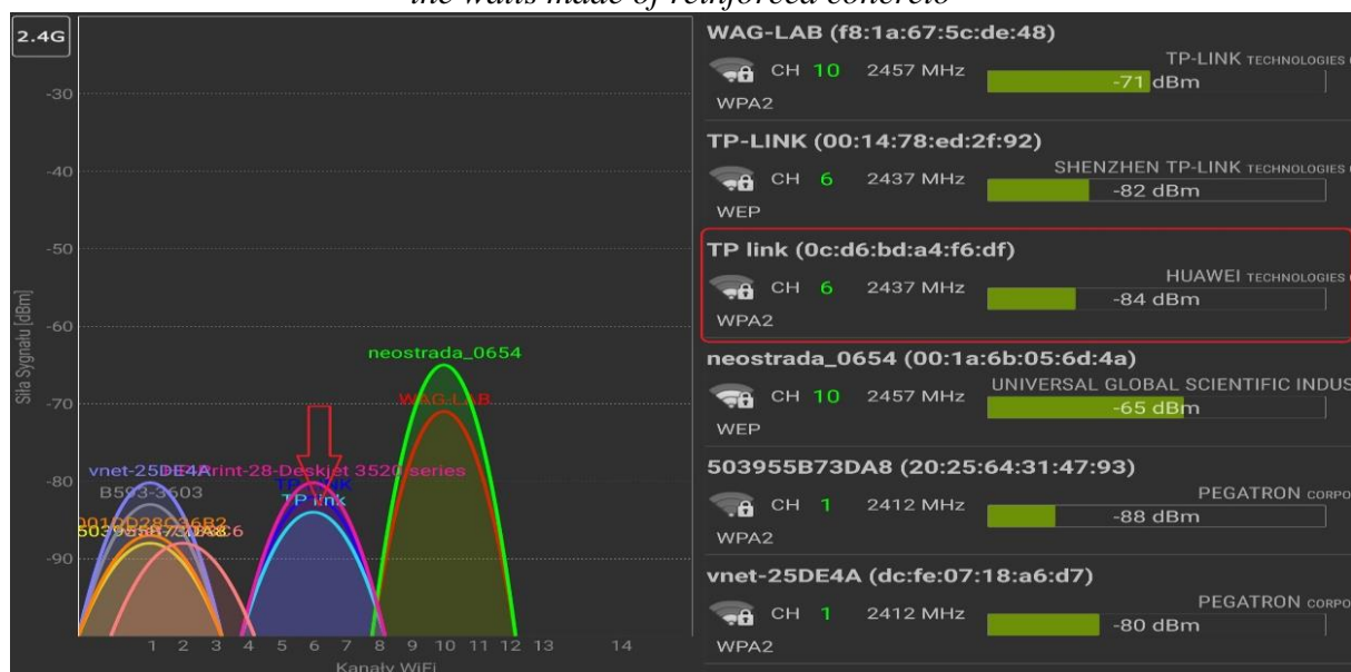
Rysunek. 6. Wykres siły sygnału sieci bezprzewodowej WiFi w odległości 15 metrów od routera dla ścian wykonanych z żelbetu
