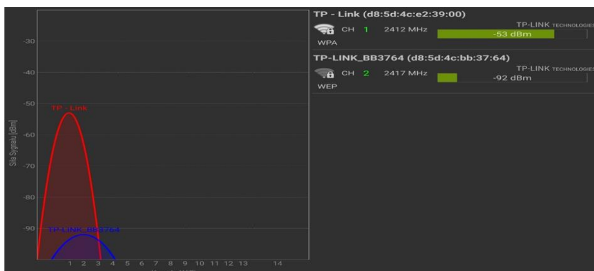
Rysunek. 3. Wykres siły sygnału sieci bezprzewodowej WiFi w odległości 15 metrów od routera dla ścian wykonanych z cegły
