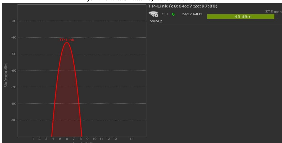
Rysunek. 8. Wykres siły sygnału sieci bezprzewodowej WiFi w odległości 10 metrów od routera dla ścian wykonanych z betonu komórkowego
