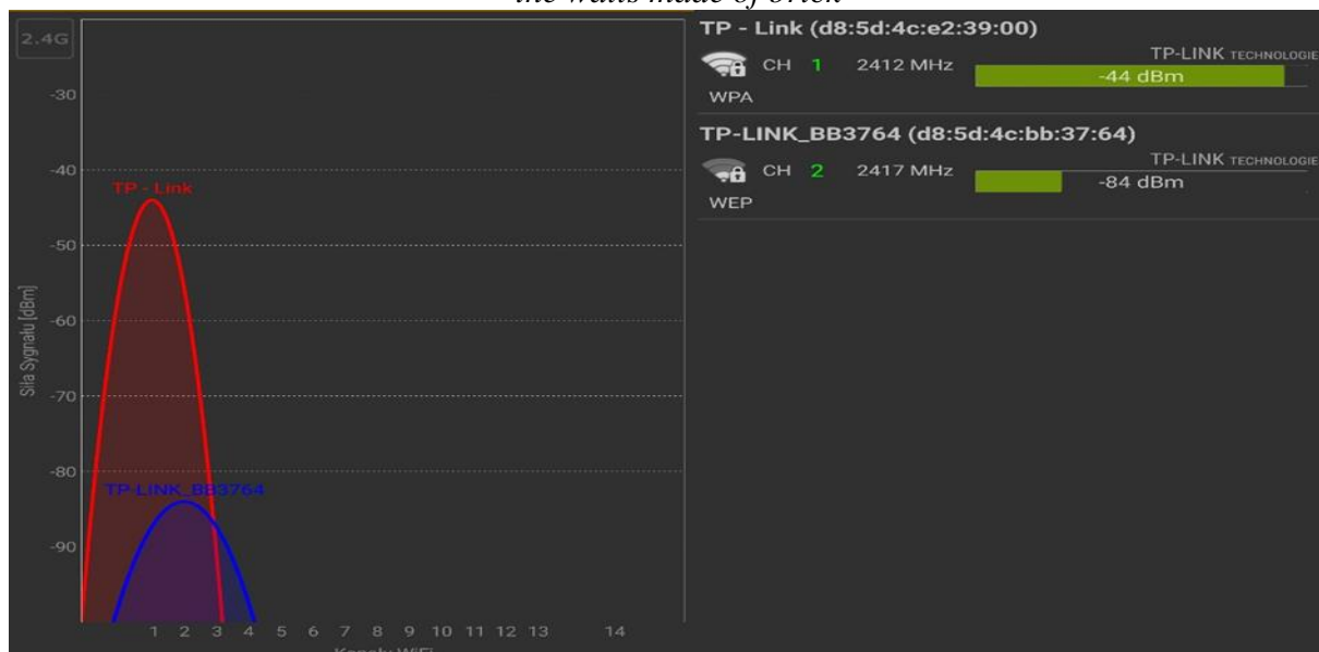
Rysunek. 2. Wykres siły sygnału sieci bezprzewodowej WiFi w odległości 10 metrów od routera dla ścian wykonanych z cegły
