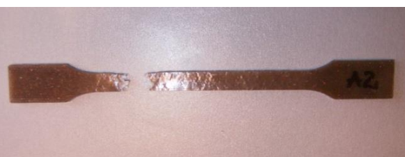
Rys.7 Próbkę po statycznej próbie rozciągania WPC- 10% mączki z łupin orzechów włoskich 500 \mu\text{m}
