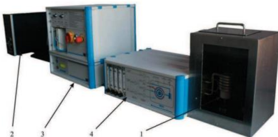
Rys. 1. Symulator UMSA, 1 – komora grzejna z cewką indukcyjną i dyszami chłodzącymi, 2 – komputer z oprogramowaniem, 3 - sterowanie mocą grzania, 4 - sterowanie gazami i cieczami chłodzącymi [1]
