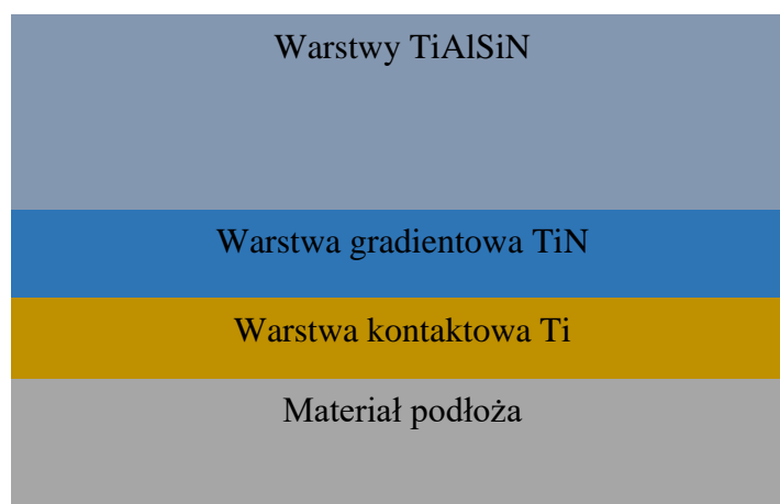
Rys. 2. Podstawowy schemat ułożenia warstw powłoki TiAlSiN [5]
