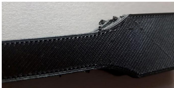
Rysunek 13. Nadlewki materiałowe powstałe w trakcie procesu wydruku
