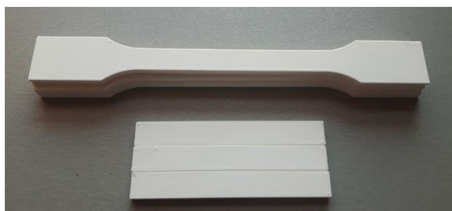
Rysunek 8. Kształtki z materiału PLA, brak defektów
