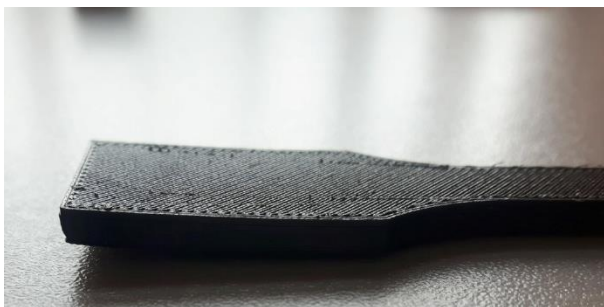
Rysunek 14. Lekko odkształcona próbka w wyniku obróbki cieplnej
