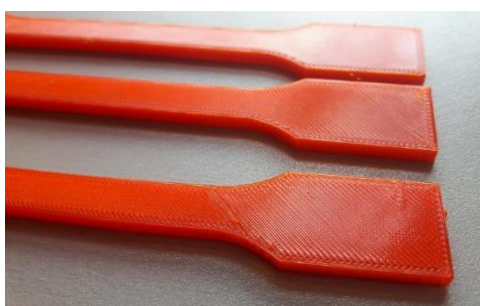
Rysunek 9. Kształtki z PET-G, charakterystyczne lśniące wykończenie powierzchni
