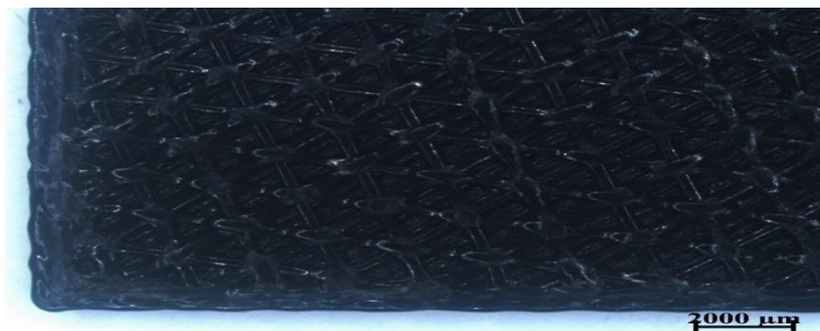
Rysunek 20. Powierzchnia próbki z nylonu, powiększenie x20
