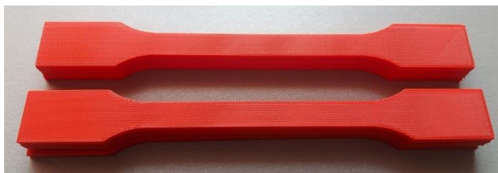
Rysunek 6. Próbkki z ABS do statycznej próby rozciągania
