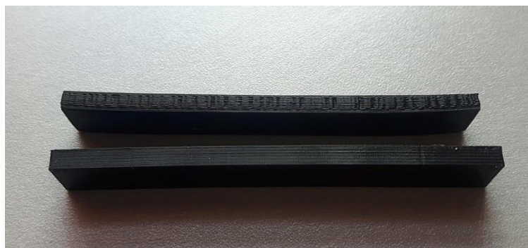
Rysunek 5. Nadlewki materiału uzyskane w niezakceptowanej pod kątem jakości wykończenia próbce prototypowej (próbka górna) oraz kształtka z satysfakcjonującą jakością wykończenia po zmniejszeniu przepływu materiału (próbka dolna)
