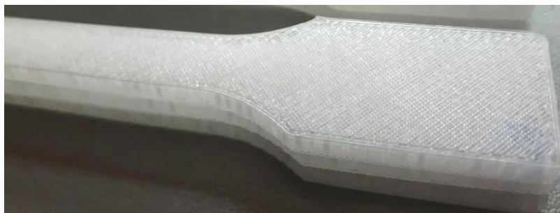
Rysunek 15. Powierzchnia kształtek wykonanych z PP- bez zastrzeżeń
