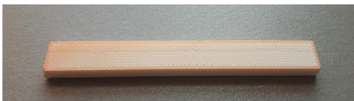
Rysunek 7. Kształtka z ABS do próby udarności odbarwiona przez kształtki do statycznej próby rozciągania podczas wygrzewania w piecu
