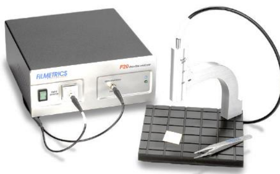
Rysunek 3. Reflektometr F20 firmy Filmetrics [10]
