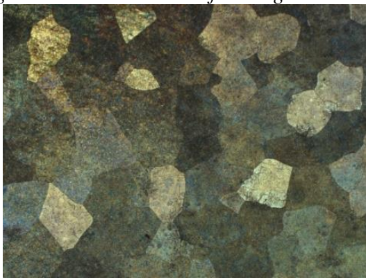
Rysunek 13. Struktura stopu Mg-12Li a) przy powiększeniu x25 b) przy powiększeniu 500 Figure 13. The structure of the Mg-12Li alloy a) x25 b) x500 magnification
