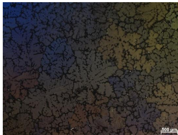
Rysunek 6. Struktura stopu Mg-4.5Li-1.5Al przy powiększeniu x25 Figure 6. The structure of the Mg-4.5Li-1.5Al alloy at x25 magnification
