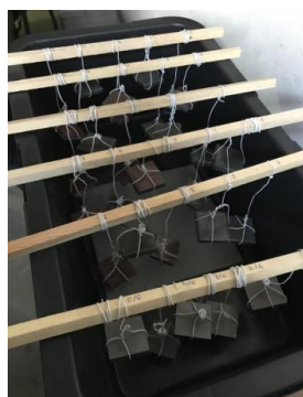
Rysunek 2. Stanowisko badawcze z zawieszonymi próbkami, przed zalaniem wodą. Figure 2. Test stand with suspended samples, before flooding with water.
