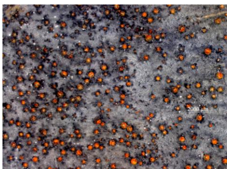
Rysunek 9. Próbką pokryta żywicą bez żadnych dodatków po 1 miesiącu, powiększenie 8x, oświetlenie pod kątem 90°. Figure 9. The sample coated with resin without any additives after one month 8x magnification, lighting for 90°.
