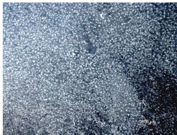
Rysunek 4. Zdjęcie próbki pokrytej żywicą epoksydową wykonane na mikroskopie stereoskopowym przy powiększeniu x8.
