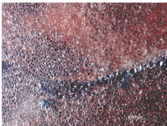
Rysunek 5. Zdjęcie próbki pokrytej żywicą epoksydową z dodatkiem miedzi wykonane na mikroskopie stereoskopowym przy powiększeniu x8.
