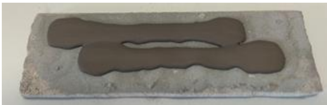
Rysunek 5. Widok próbek wykonanych z mieszanki M1 po degradacji termicznej Figure 5. View of samples manufactured from mixture M1 after thermal debinding
