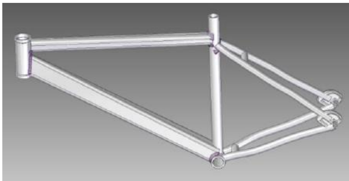
Rysunek 3. Złożenie modelu badanej ramy roweru MTB w programie Solid Edge ST9
