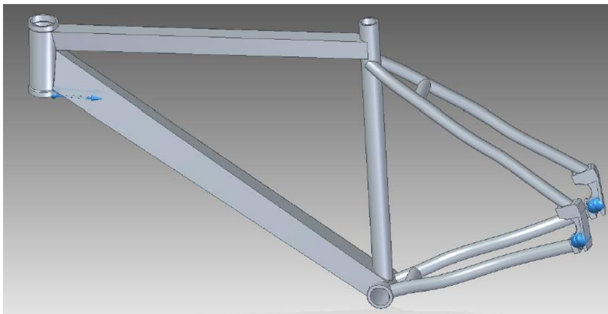
Rysunek 6. Miejsca oraz rodzaj utwierdzenia modelu ramy w pierwszym wariantcie badania Figure 6. Miejsca oraz rodzaj utwierdzenia modelu ramy w pierwszym wariantcie badania
