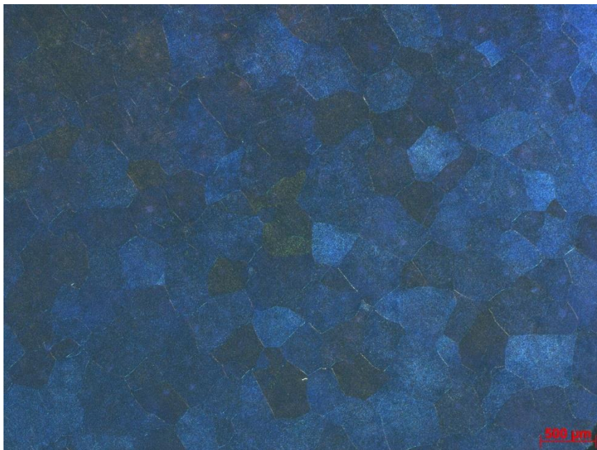
Rys. 12. Mikrostruktura stopu Mg 12 Li 1.5 Al modyfikowanego Tiborem i Sr Fig. 12. Microstructure of Mg 12 Li 1.5 Al alloy modified with Tibor and Sr
