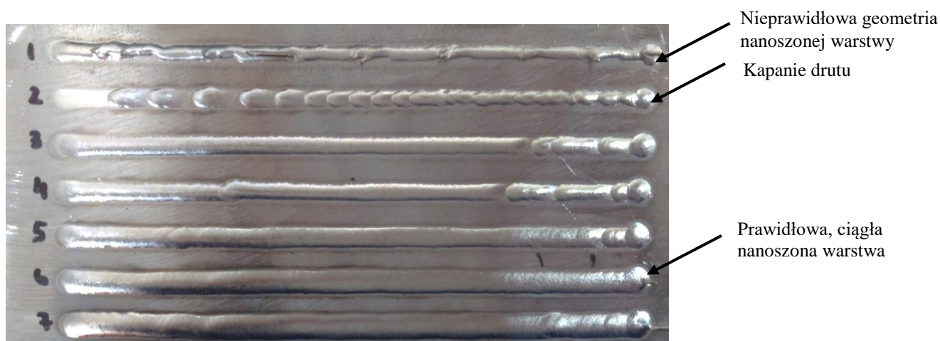
Rysunek 3. Zdjęcie pojedynczych deponowanych warstw stali nierdzewnej 308LSi
