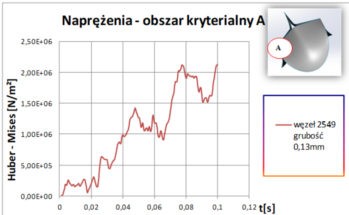
Rysunek 5 Zmiany naprężenia zredukowanego H-M w obszarze A podczas wzrostu ciśnienia krwi
