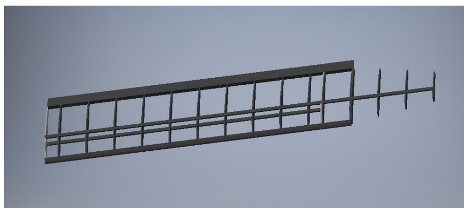
Rysunek 7. Złożenie wzmocnienia skrzydła szybowca Figure 7. Folding the glider wing reinforcement
