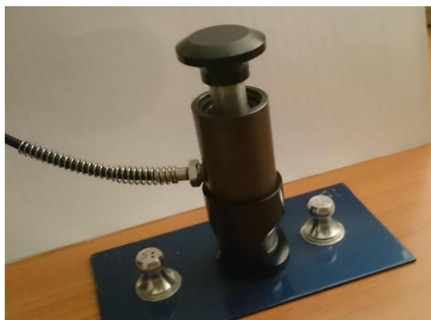
Rysunek 12. Uchwyt stosowany w badaniu przyczepności powłok metodą pull-off [24] Figure 12. Handle used in pull-off method of coating adhesion testing [24]
