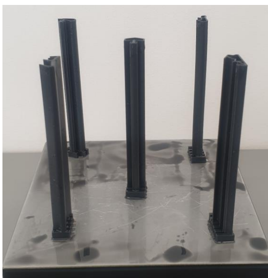
Rysunek 4. Gotowy wydruk na platformie roboczej z widocznymi podporami pomocniczymi Figure 4. Ready printout on the working platform with visible auxiliary supports
