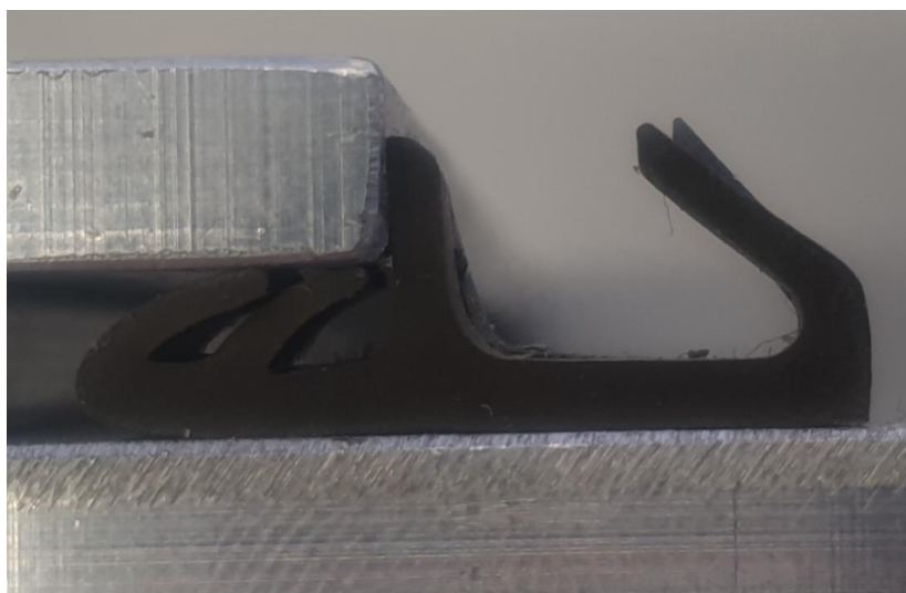
Rysunek 12. Porównanie osadzenia profilu S 4050 wykonanego z TPE (pierwszy plan) oraz w technologii SLA (drugi plan)
