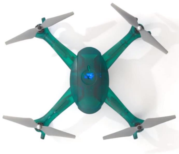
Rysunek 1. Dron wydrukowany metodą SLA [6]
