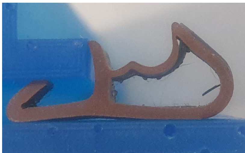
Rysunek 13. Porównanie osadzenia profilu S 50 wykonanego z TPE (pierwszy plan) oraz w technologii SLA (drugi plan)
