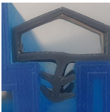
Rysunek 6. Porównanie osadzenia profilu S 7292 wykonanego z TPE (profil na drugim planie) oraz w technologii SLA (pierwszy plan)
