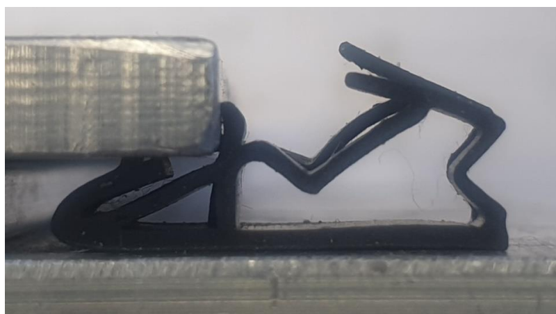
Rysunek 9. Porównanie osadzenia profilu SV 12 wykonanego z TPE (pierwszy plan) oraz w technologii SLA (drugi plan)
