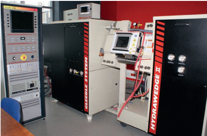
Rys. 1. Symulator obróbki cieplno-plastycznej Gleeble 3800, będący na wyposażeniu Laboratorium Naukowo-Dydaktycznego Nanotechnologii i Technologii Materiałowych Instytutu Materiałów Inżynierskich i Biomedycznych Politechniki Śląskiej
