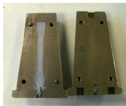
Rys.8. Formy przeznaczone do formowania wtryskowego proszku
