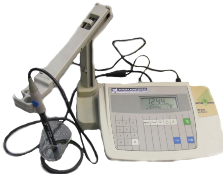
Rys. 5. Pomiar pH wyciągu wodnego z betonu modelującego w przybliżeniu ciecz porową betonu
