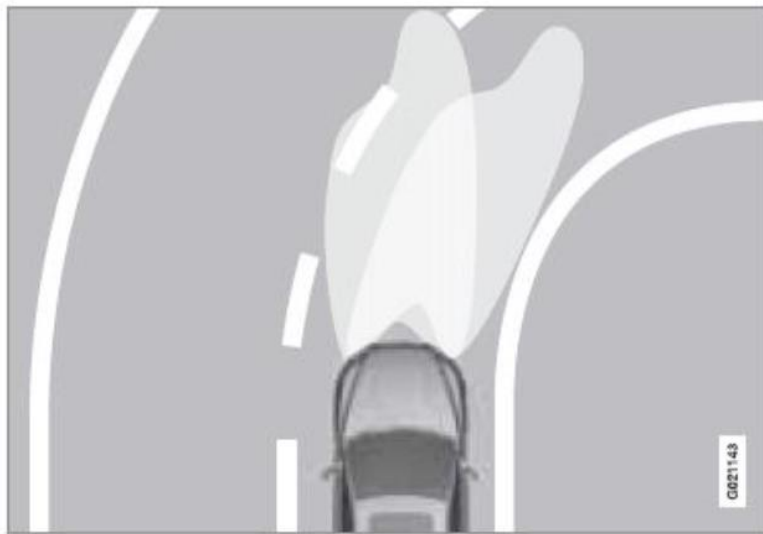
Rys.2 Przykład systemu aktywnego – system doświetlający drogę AFS [2]
