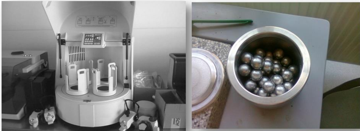
Rysunek 6. Wysokoenergetyczny planetarny młyn kulowy PULVERISETTE 5
