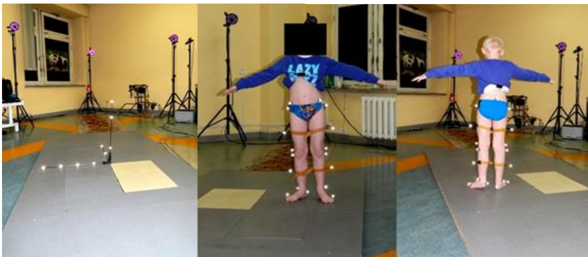
Rys. 3. Stanowisko pomiarowe systemu BTS podczas kalibracji oraz rozmieszczenie markerów na ciele badanego
