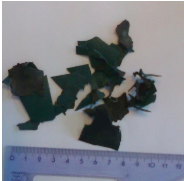
Rys.3.2. Badany odpad folii PVC [2].
