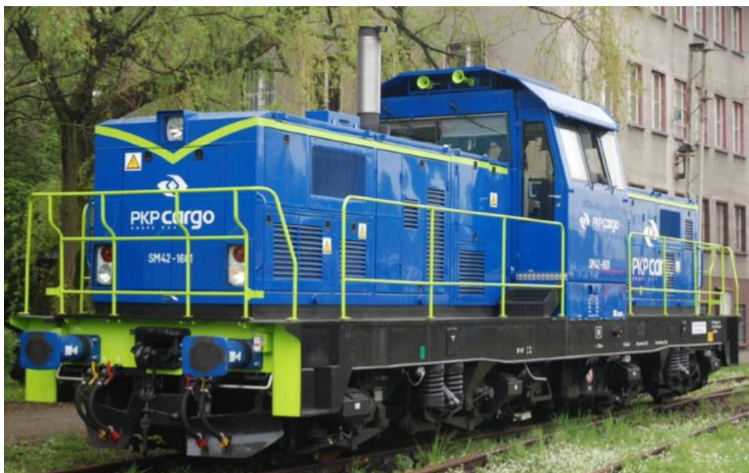
Fot. 2 – Lokomotywa zmodernizowana SM-42 wersja 6Dk.
