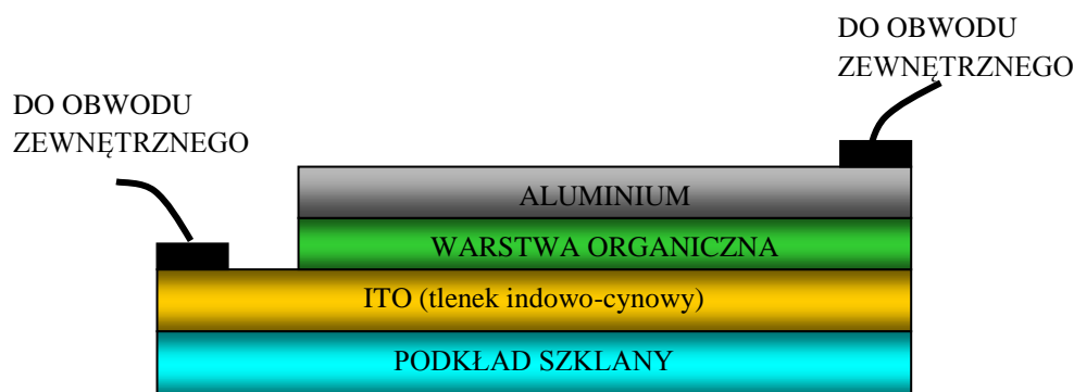
Rys. 9. Schemat budowy komórki typowego organicznego ogniwa słonecznego [18]
