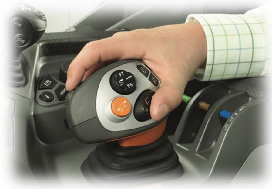
Rysunek 3. Wielofunkcyjny manipulator stosowany w maszynach rolniczych [4]
