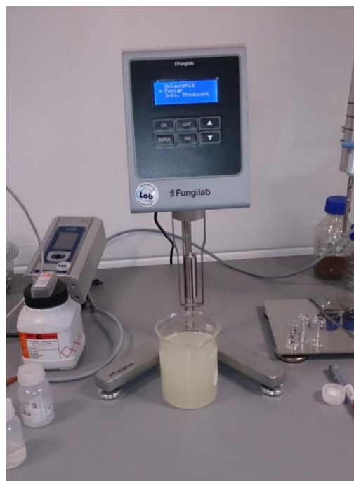
Rys. 1. Lepkościomierz rotacyjny firmy Fungilab.
