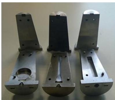
Rys.8. Formy przeznaczone do formowania wtryskowego proszku
