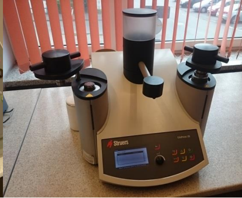
Rys. 2. CitoPress-20 mounting machine [opracowanie własne]
