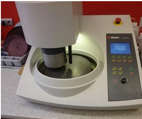
Rys. 3. Tegramin-30 automatic grinding/polishing machine [opracowanie własne]
