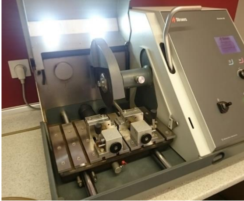
Rys. 1. Discotom-60 automatic cut machine [opracowanie własne]
