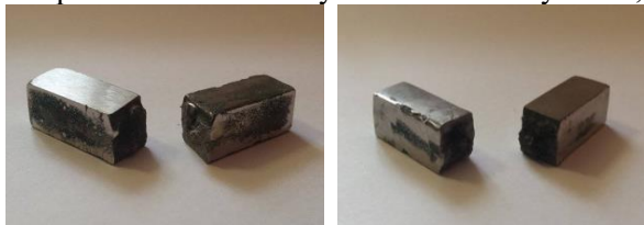
Rysunek 4. Widok próbek ze stopu Co-Cr po badaniu udarności
