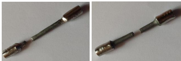
Rysunek 5. Widok próbek ze stopu Co-Cr po badaniu wytrzymałości na rozciąganie
