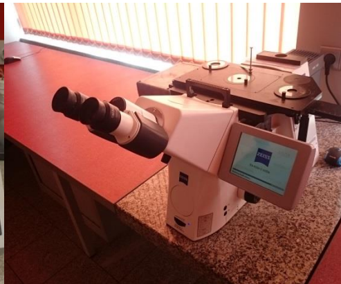
Rys. 4. ZEISS Observer Z1m light microscope [opracowanie własne]
