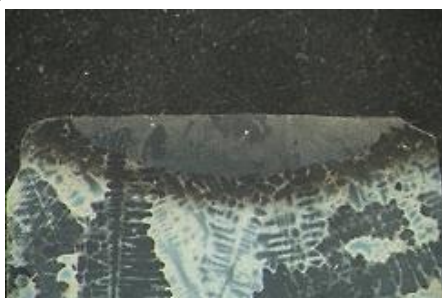
Rysunek 4. Makrostruktura przetopień i napoin wykonanych łukiem plazmowo – proszkowym przy natężeniu prądu spawania 20A: a) 0% proszku, b) 2,5% proszku, c) 4% proszku, d) 6% proszku [Opracowanie własne]
