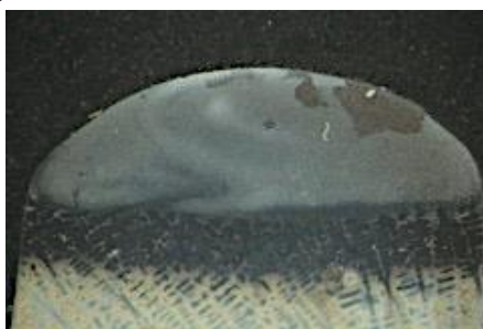
Rysunek 5. Makrostruktura przetopień i napoin wykonanych łukiem plazmowo – proszkowym przy natężeniu prądu spawania 25A: a) 0% proszku, b) 2,5% proszku, c) 4% proszku, d) 6% proszku [Opracowanie własne]
