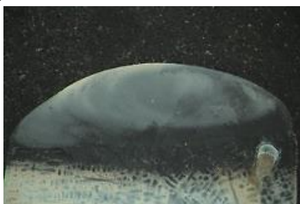
Rysunek 4. Makrostruktura przetopień i napoin wykonanych łukiem plazmowo – proszkowym przy natężeniu prądu spawania 20A: a) 0% proszku, b) 2,5% proszku, c) 4% proszku, d) 6% proszku [Opracowanie własne]
