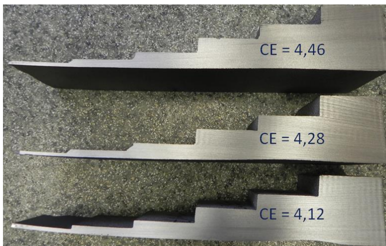
Rysunek 8. Porównanie odlewów modeli schodkowych [Opracowanie własne na podstawie [2]]
