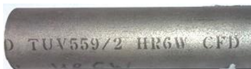
Rysunek 1. Wycinek węzownicy przegrzewacza pary ze stopu HR6W (23Cr-45Ni-6W-Nb-Ti-B) [Opracowanie własne]
