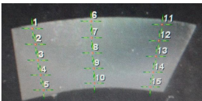
Rysunek 7. Miejsca pomiaru twardości [Opracowanie własne]
