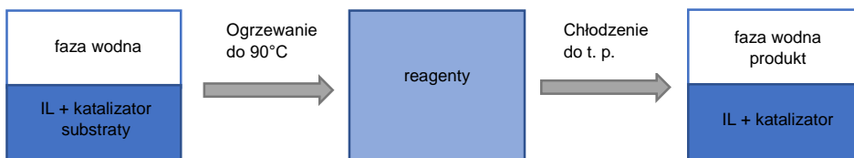
Rysunek 8. Ideowy schemat procesu utleniania p -nitrotoluenu [17]
