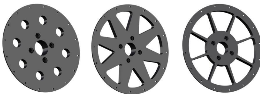
Rysunek 7. Wybrane warianty obręczy koła (wariant wejściowy I – po lewej, wariant wejściowy II – w środku, wariant po optymalizacji – po prawej) [4]
