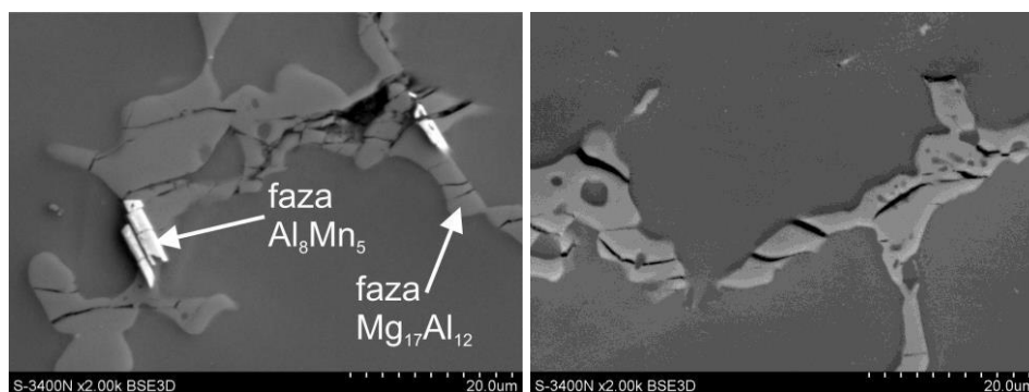
Rysunek 5. Pęknięcia międzykrystaliczne w fazach \beta ( Mg_{17}Al_{12} ) i fazach Al_8Mn_5 [opracowanie własne]
