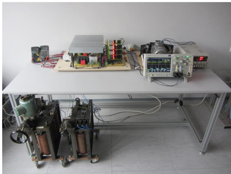
Rysunek 6. Widok stanowiska pomiarowego do identyfikacji parametrów synchronicznego silnika reluktancyjnego [11]
