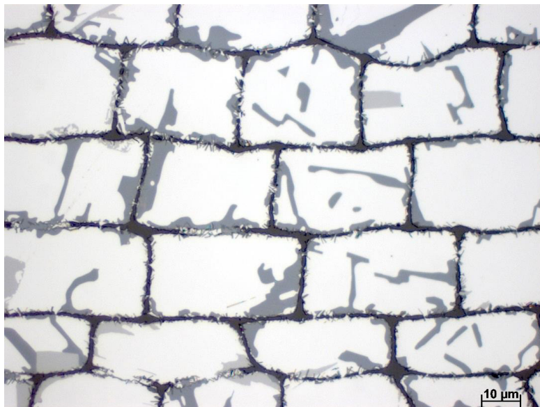
Rysunek 4. Widok poprzeczny materiału kompozytowego Al/C z widocznymi igłami fazy Al 4 C 3 na ściankach węglowej fazy wzmacniającej oraz składnikami stopu eutektycznego AlSi12. Mikroskop świetlny, pow. 1000x [opracowanie własne]
