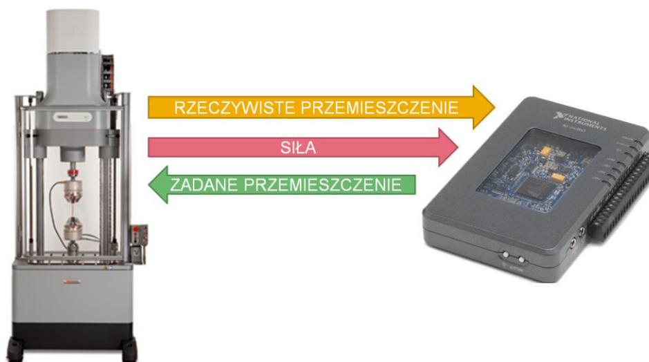
Rysunek 5. Urządzenia wykorzystane w eksperymencie oraz schemat komunikacji między nimi [7]
