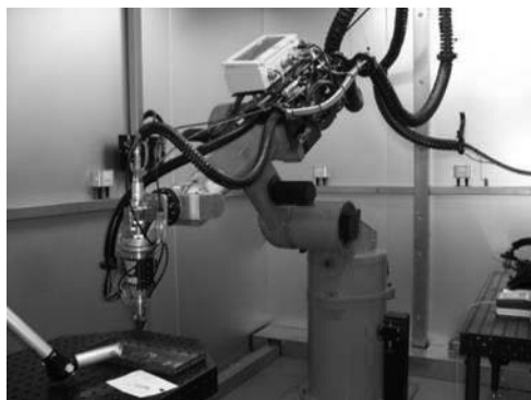
Rysunek 2. a) Stanowisko zrobotyzowane- robot REIS RV-30-26, b) Głowica optyczna systemu laserowego z koaksjalnym podajnikiem proszku- laser włóknowy YLS-4000 Figure 2. a) Robotized station - REIS RV-30-26 robot, b) Optical head of the laser system with a coaxial powder feeder - YLS-4000 fiber laser
