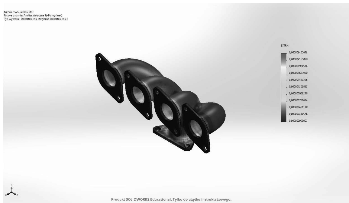
Rys. 25. Wynik odkształcenia dla zastosowanych warunków: stal 1.4541, ciśnienie 0,004[MPa]. Fig. 25. Result of deformation for the applied conditions: 1.4541 steel, pressure 0.004[MPa].
