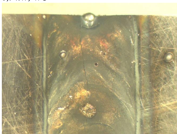
Rysunek 6. Lico przetopienia stali HS6-5-2 w fazie początkowej przetapiania; gęstość mocy wiązki 2,0 kW; WC
