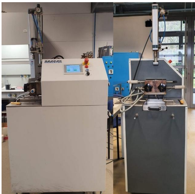
Rysunek 1. Gniotownik Zamak Mercator
