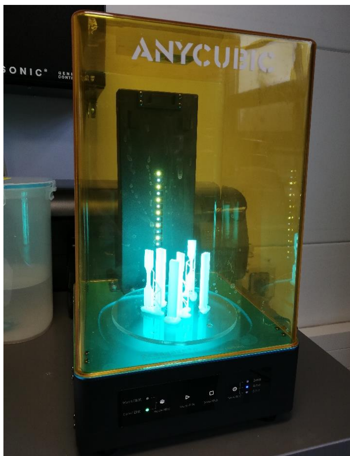
Rys. 5. Utwardzanie próbek światłem UV Figure 5. Curing samples with UV light
