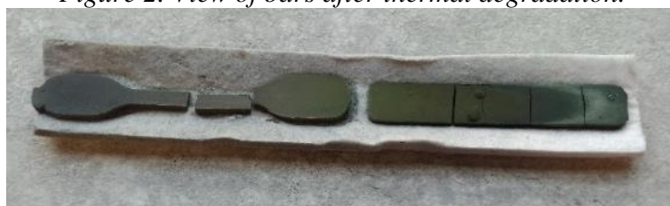
Rysunek 3. Widok próbek po degradacji i spiekaniu. Figure 3. View of bars after debinding and sintering.
