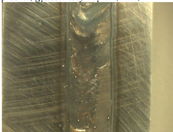
Rysunek 4. Lico przetopienia stali HS6-5-2 po laserowym przetopieniu; gęstość mocy wiązki 0,7 kW; WC
