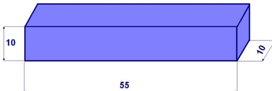
Rysunek 2 Kształt i wymiar próbek: próbka spiekanej stali austenitycznej Cr-Ni-Mo
