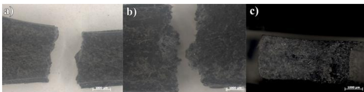
Rysunek 12. Zdjęcia przełomów polipropylenu z niemodyfikowanym krzemianem ilastym w stosunku 95:5, a) powiększenie 15x, b) powiększenie 20x, c) powiększenie 20x
