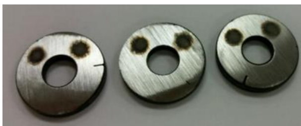
Rysunek.2 Wypraski z miejscami, w których określono skład chemiczny
