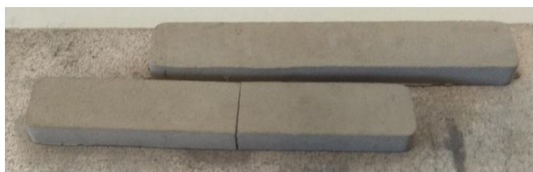
Rysunek 2. Widok belek po degradacji termicznej. Figure 2. View of bars after thermal degradation.
