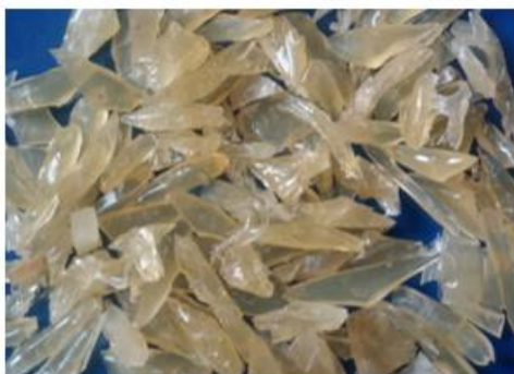
Rysunek 3. PLA z dodatkiem a) 1 ml, b) 2 ml olejku kawowego Figure 3. PLA with the addition of a) 1 ml, b) 2 ml of coffee oil
