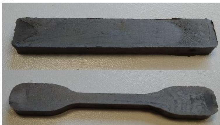
Rysunek 1. Widok próbek po formowaniu wtryskowym. Figure 1. View of samples after injection moulding.
