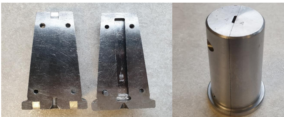
Rysunek. 1. Matryca dwudzielna stosowana we wtryskarce tłokowej firmy Zamak Mercator Figure 1. A two-part die used in a Zamak Mercator piston injection molding machine
