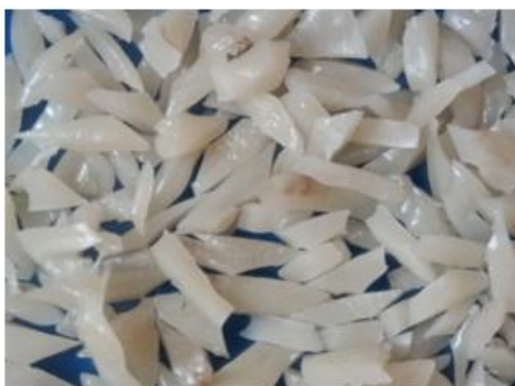
Rysunek 4. PLA z dodatkiem a) 1 ml, b) 2 ml olejku migdałowego Figure 4. PLA with the addition of a) 1 ml, b) 2 ml of almond oil
