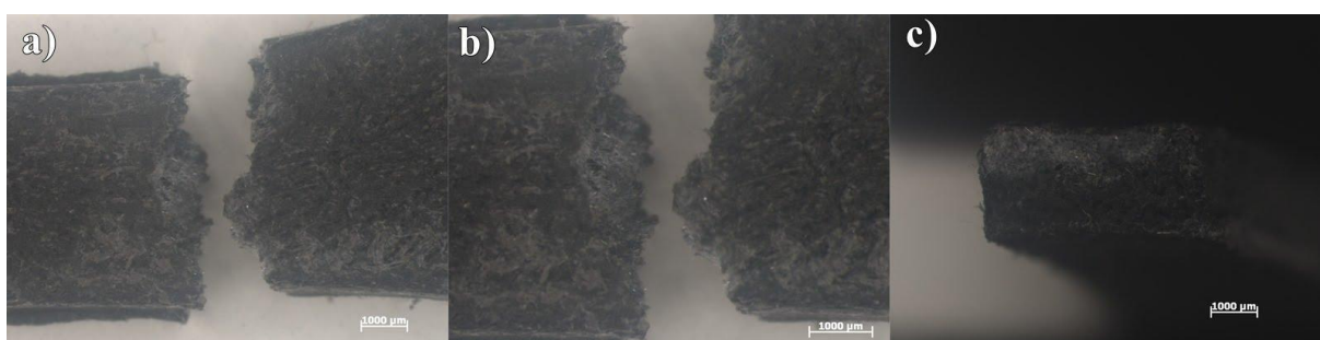
Rysunek 13. Zdjęcia przełomów polipropylenu z niemodyfikowanym krzemianem ilastym w stosunku 90:10, a) powiększenie 15x, b) powiększenie 20x, c) powiększenie 20x
