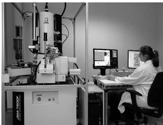
Rysunek 2. Mikroskopu skaningowy JSM-7200F firmy JEOL Figure 2. Scanning microscope JSM-7200F firmy JEOL
