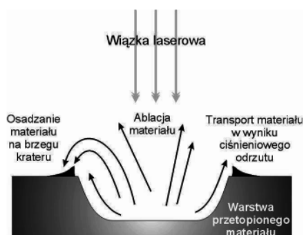
Rysunek. 3. Schemat przebiegu zjawisk podczas wykorzystania ablacji laserowej[6]
