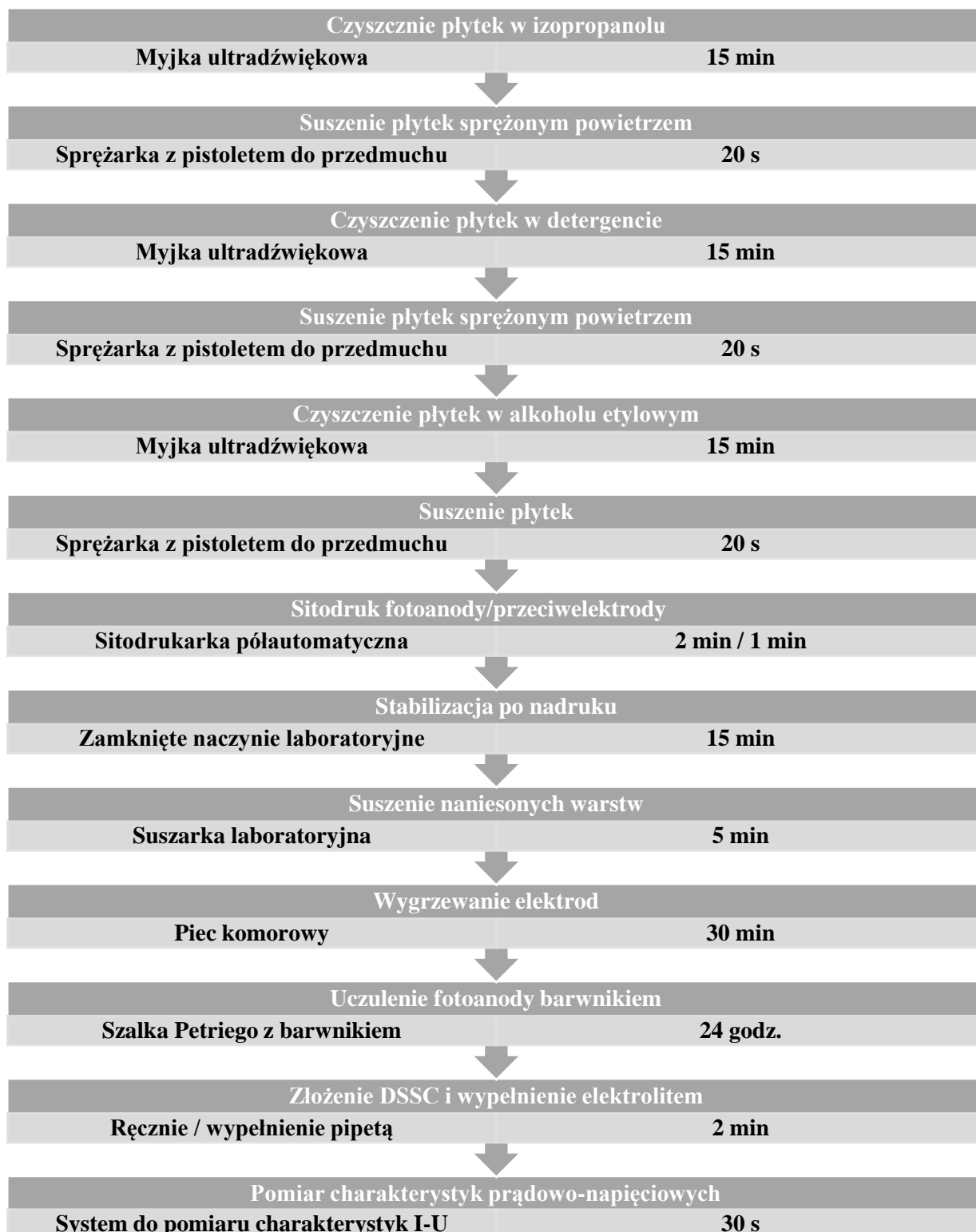
Rysunek 1. Proces wytwarzania DSSC w skali laboratoryjnej
