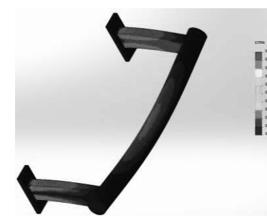
Rysunek 14. Wartości odkształceń dla siły 1000 N Figure 14. Deformation value for force 1000 N
