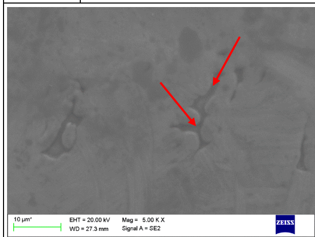
Rys. 8 Morfologia powierzchni powłoki galwanicznej Ni5 na stali SEM pow.5000x Surface morphology of Ni5 galvanic coating on steel
