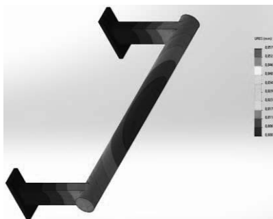
Rysunek 9. Wartości przemieszczeń dla siły 200 N Figure 9. Value of displacements for force 200 N
