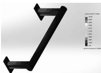
Rysunek 6. Wartość naprężeń dla siły 200 N Figure 6. Stress value for force 200N
