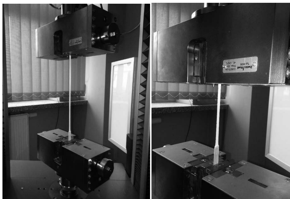
Rysunek 3. Przykładowe zdjęcia z oznaczania wytrzymałości na rozciąganie Figure 3. Example photos of tensile strength determination
