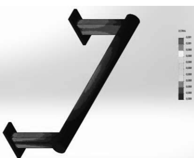
Rysunek 13. Wartości odkształceń dla siły 500 N Figure 13. Deformation value for force 500 N
