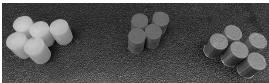
Rysunek 4. Próbkki do statycznej próby ściskania wykonane zgodnie z normą ISO 604 Figure 4. Static compression test specimens made in accordance with ISO 604
