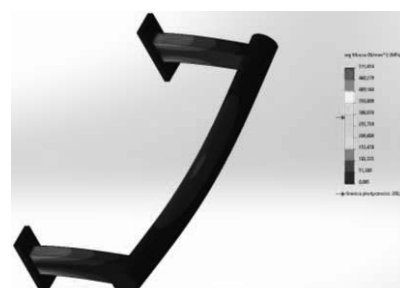
Rysunek 8. Wartość naprężeń dla siły 1000 N Figure 8. Stress value for force 1000N
