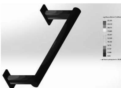
Rysunek 7. Wartość naprężeń dla siły 500 N Figure 7. Stress value for force 500N
