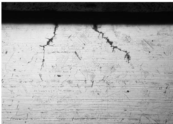
Obr. 6. Korózne praskanie nehrdzavejúcej ocele AISI 316L [2]
