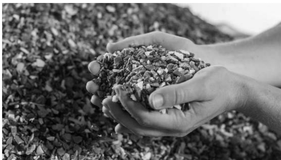
Rysunek 3. Kształt stosowanego reglanulatu z tworzyw sztucznych [10] Figure 3. The shape of used recycleate from plastic materials [10]
