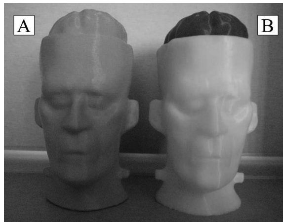
Rysunek 7. Element powielony w inżynierii odwrotnej (A) i element oryginalny (B) Figure 7. Element duplicated in reverse engineering (A) and original element (B)
