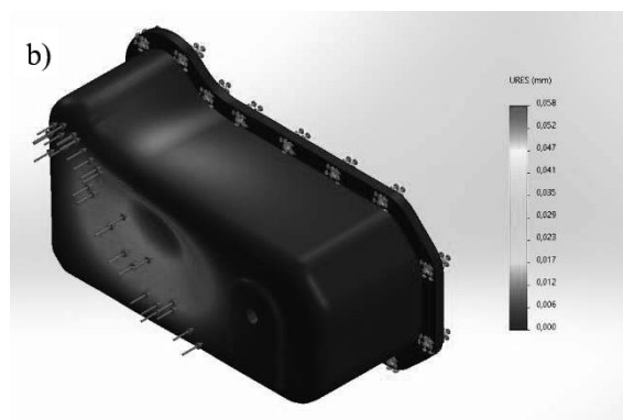
Rys. 10. Stal konstrukcyjna wzmocniona żebrowaniem na ścianach bocznych:
