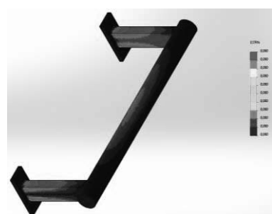
Rysunek 12. Wartości odkształceń dla siły 200 N Figure 12. Deformation value for force 200 N
