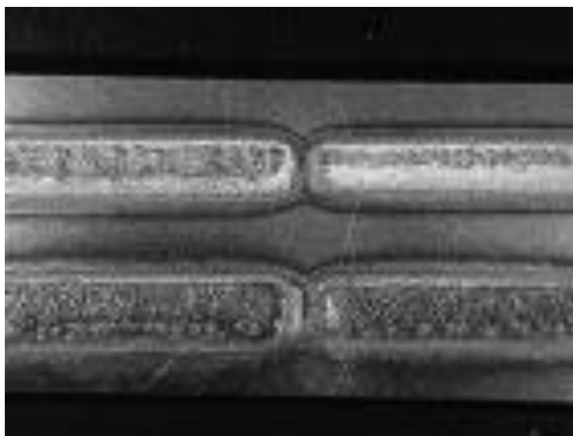
Rysunek 2. Ściegi przetopienia stali 32CrMoV12-28 o mocach kolejno: 1,2; 1,6; 2,0; 2,3 z użyciem NbC; na rysunku przekrój poprzeczny próbki doświadczalnej Figure 2. Remelting passes of 32CrMoV12-28 steel with the following powers: 1.2; 1.6; 2.0; 2.3 using NbC; in the figure, a cross-section of the experimental sample
