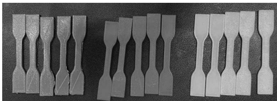
Rysunek 3. Próbkki do statycznej próby rozciągania wykonane zgodnie z normą PN-EN ISO 527:2
