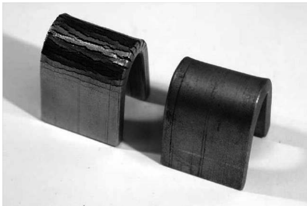
Obr. 7. Medzikryštálová korózia [19] Figure 7. Intercrystalline corrosion [19]
