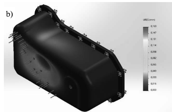
Rys. 12. Aluminium wzmocnione żebrami na ścianach bocznych: Fig. 12. Aluminium with reinforcements:
