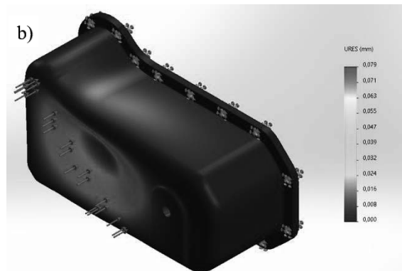
Rys. 9. Stal konstrukcyjna bez wzmocnień Fig. 9. Structural steel without reinforcements:
