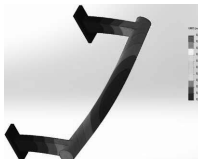
Rysunek 11. Wartości przemieszczeń dla siły 1000 N Figure 11. Value of displacements for force 1000 N
