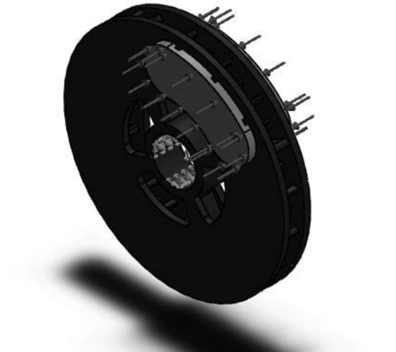
Rys. 6. Umocowania oraz obciążenia zewnętrzne przyjęte w analizie Fig. 6. Constants and applied forces
