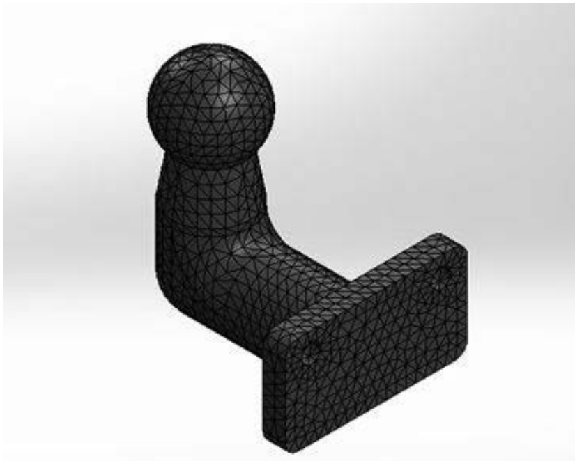
Rysunek 4. Model haka z naniesioną siatką (zdyskretyzowany) Figure 4. Numerical model of towbar
