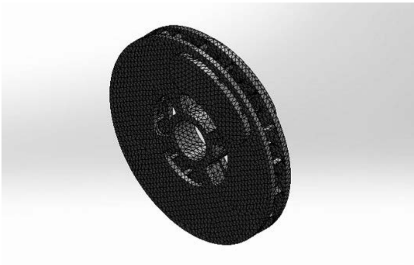
Rys. 7. Złożenie po wygenerowaniu siatki Fig. 7. Assembly with generated mesh
