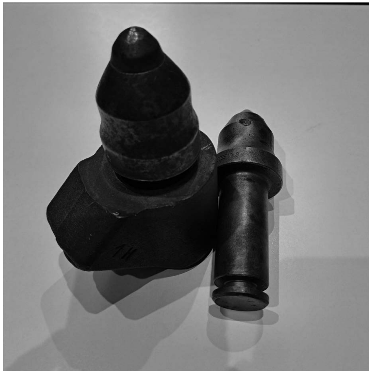
Rys. 1. Przykład noża stożkowego stosowanego w kombajnach tunelowych wraz z uchwytem montażowym [Opracowanie własne].
