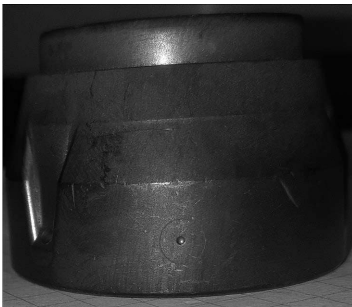
Rysunek 7. Przewodnica pręta z zaznaczonym miejscem badania metodą Rockwell'a Figure 7. Rod guide with Rockwell test area marked
