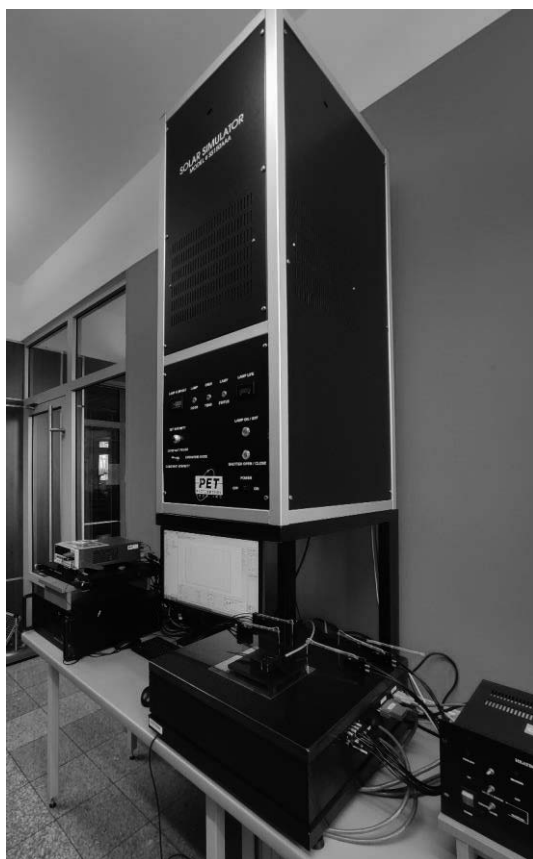
Rysunek 4. System do pomiaru charakterystyk prądowo-napięciowych Figure 4. System for measuring current-voltage characteristics
