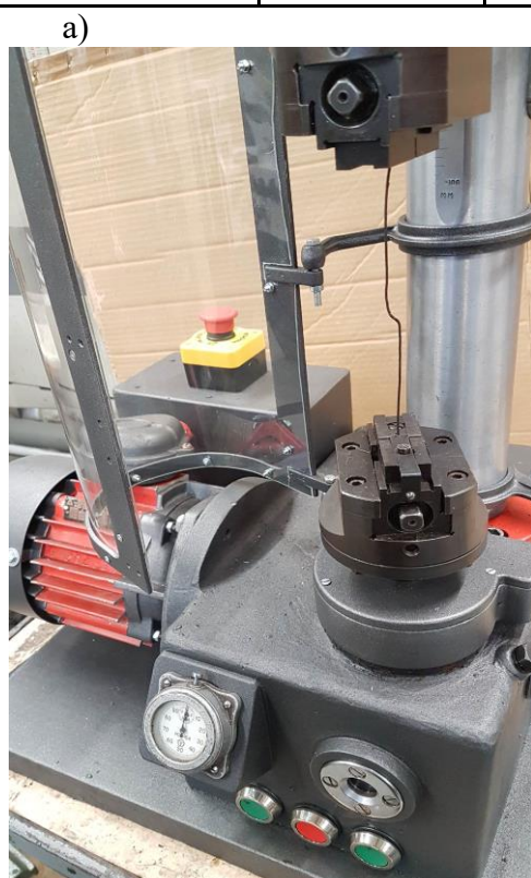
Rys. 1. a) Odnowiona skręcarka do drutów w czasie wykonywania badań, b) schemat stanowiska badawczego
