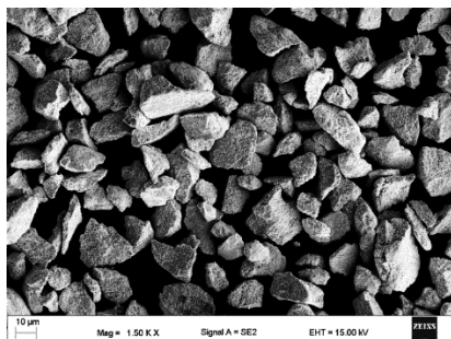
Rysunek 1 Morfologia proszku WC-Co-Cr użytego do natryskiwania cieplnego, SEM
