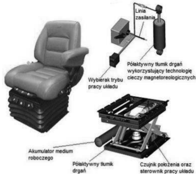
Rysunek 5. Fotel kierowcy z systemem tłumienia drgań wykorzystującym technologię cieczy MR [13]
