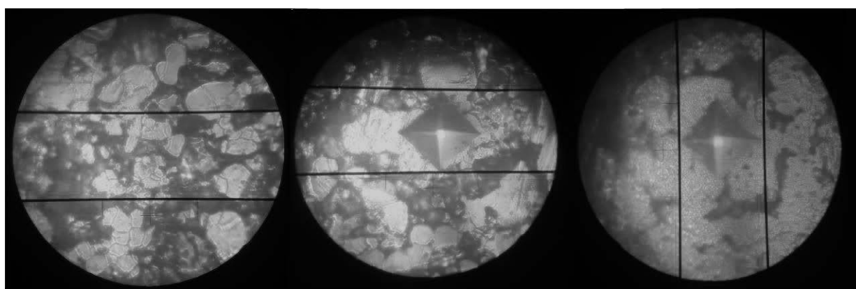
Rysunek 8. Zdjęcia mikroskopowe (od lewej): powierzchnia próbki, pełny odcisk, delikatnie odkształcony odcisk Figure 8. Microscopic photos (from left): sample surface, full print, slightly deformed print
