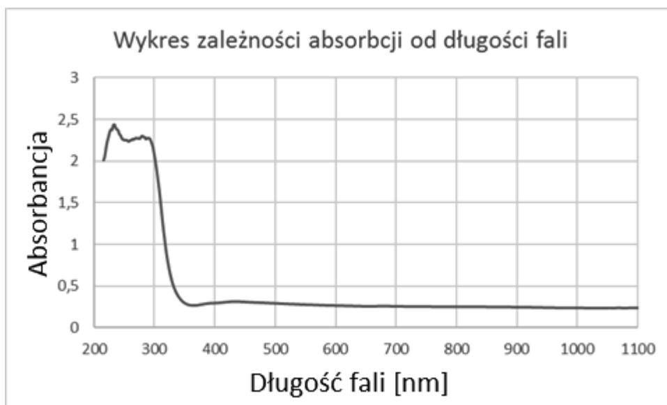
Rysunek 8 Widmo UV-Vis nanowłókien \text{CeO}_2 Figure 8 UV-Vis spectrum of \text{CeO}_2 nanofibers
