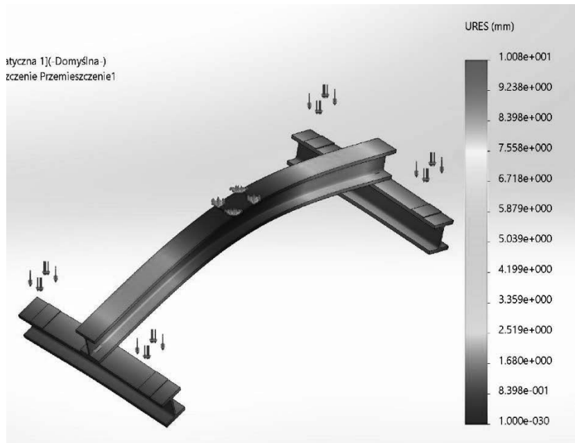
Rys. 13. Rozkład przemieszczeń dla pierwszej trawersy ze stopu aluminium Fig. 13. Displacement distribution for first traverse made of aluminium alloy
