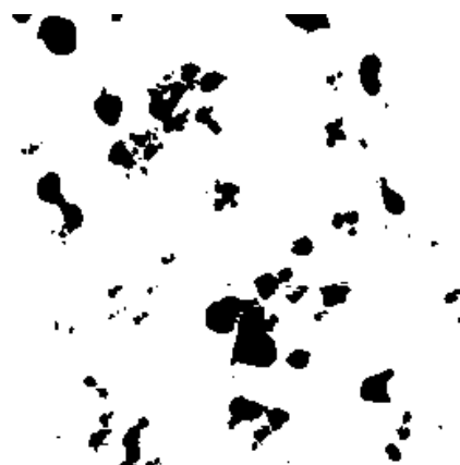
Rysunek 32. Topografia 2D powłoki PVP+15%SnO 2 (w skali szarości) - wyznaczenie skupisk SnO 2 Figure 32. 2D topography of PVP+15%SnO 2 spin-coated layer (grayscale) - designation of SnO 2 clusters
