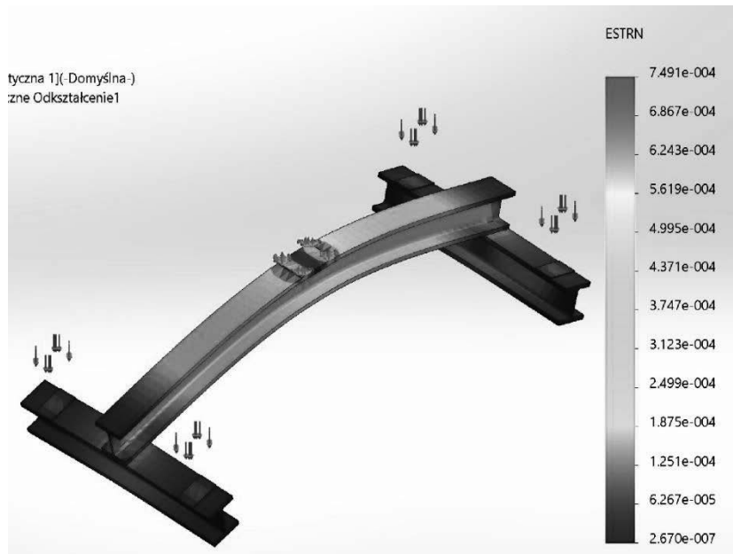
Rys. 17. Odkształcenie równoważne dla pierwszej trawersy ze stopu aluminium Fig. 17. Buckling deformation for first traverse made of aluminium alloy
