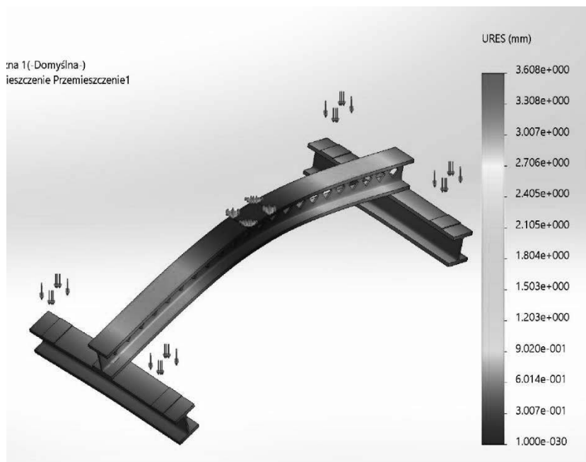
Rys. 14. Rozkład przemieszczeń dla drugiej trawersy ze stali stopowej Fig. 14. Displacement distribution for second traverse made of alloyed steel
