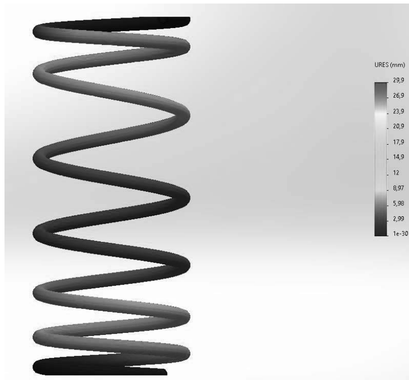
Rys. 16. Wyniki analizy przemieszczenia dla siły o wartości 4000 N. Figure 16. Displacement distribution for 4000 N load.
