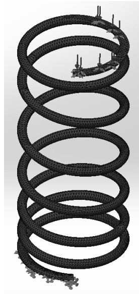
Rys. 8. Punkty umocowania i przyłożenia siły.
