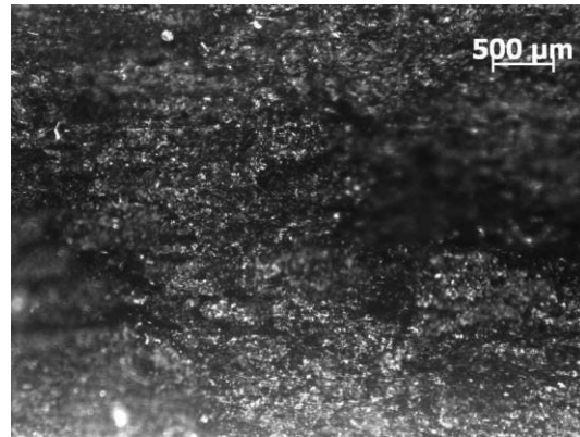
Rysunek 6. Obrazy makroskopowe próbek drukowanych we wzorze Quarter Cubic Figure 6. Macroscopic images of samples printed in the Quarter Cubic pattern
