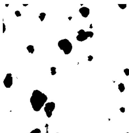
Rysunek 28. Topografia 2D powłoki PVP+10%SnO 2 (w skali szarości) - wyznaczenie skupisk SnO 2 Figure 28. 2D topography of PVP+10%SnO 2 spin-coated layer (grayscale) - designation of SnO 2 clusters
