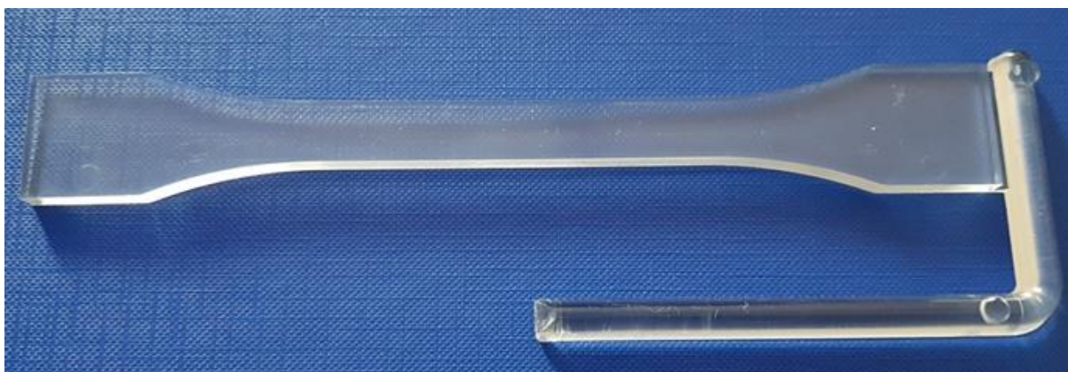
Rysunek 3. Kształtka do badania na rozciąganie; widoczny kanał doprowadzający. Figure 3. Molding in the shape of tensile specimen; visible hot runner channel.
