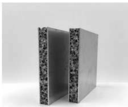
Obr. 4. Akustický panel vyrobený z penového hliníka [7] Figure 4. Acoustic panel made of aluminum foam [7]
