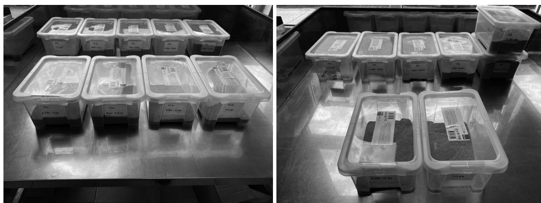
Rysunek 1. Frakcje haloizytu kalcynowanego i surowego po przesianiu Figure 1. Calcined and rough halloysite fractions after sieving
