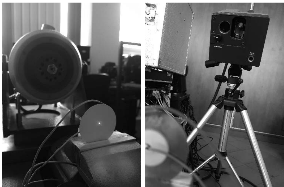
Rysunek 5 Badania drgań przy użyciu wibrometru Polytec PSV-400 Figure 5 Vibration tests using the Polytec PSV-400 vibrometer
