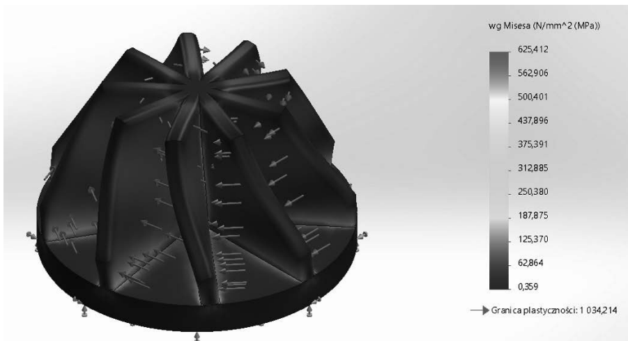
Rysunek 6. Rozkład naprężeń zredukowanych wg. Hubera-Misesa dla stopu Ti-3Al-8V-6Cr-4Mo-4Zr (SS) Figure 6. Huber-Mises stress reduction distribution for Ti-3Al-8V-6Cr-4Mo-4Zr alloy (SS)
