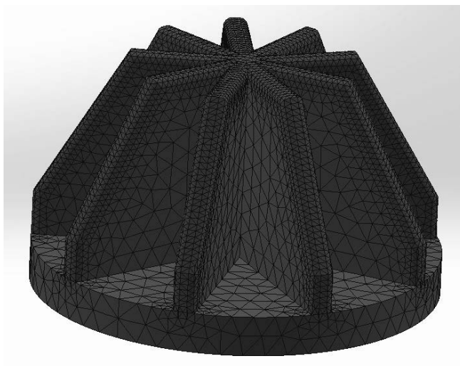
Rysunek 3. Model CAD z nałożoną siatką elementów skończonych Figure 3. CAD model with superimposed finite element mesh
