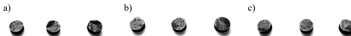
Rysunek 3. Wytworzone próbki przy użyciu wiertła o średnicy a) 200, b) 300 oraz c) 400 \mu\text{m} Figure 3. Prepared samples using a drill with a diameter of a) 200, b) 300, and c) 400 \mu\text{m} .
