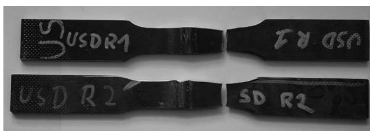
Rysunek 5. Próbki złączy spawanych po badaniu statycznej próby rozciągania [11]
