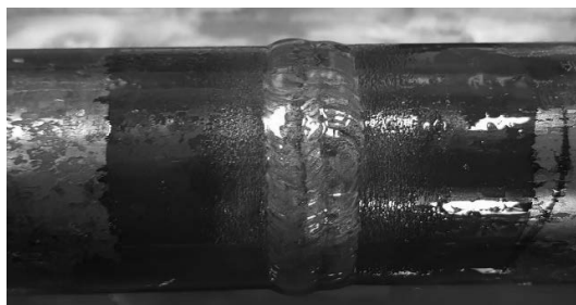
Rysunek 1. Próbką z naniesioną cieczą wnikającą – penetrant (po lewej) Figure 1. Sample with penetrant liquid applied – penetrant (left)
