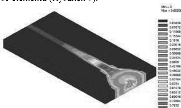
Rysunek 8. Symulacja przepływu ciepła w procesie spawania [15]. Figure 8. Simulation of heating in the welding process [15].
