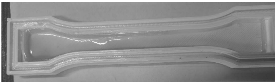
Rysunek 1. Forma do próbek wytworzona za pomocą techniki przyrostowej wykonana z polilaktydu [opracowanie własne]
