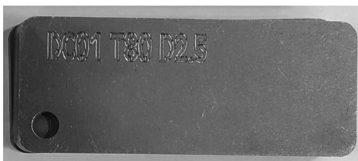
Rysunek 2. Próbkę ze stali DC01 przed cynkowaniem galwanicznym
