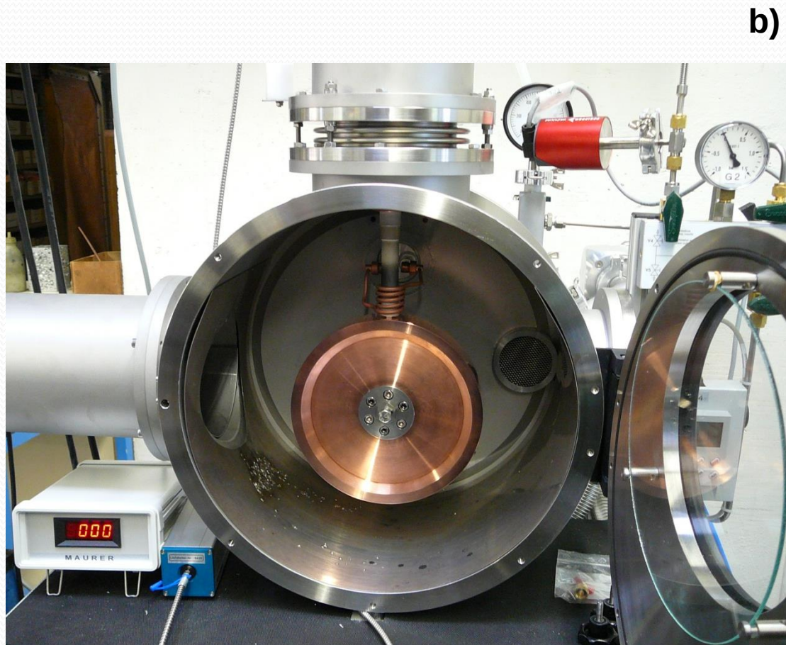
Stanowisko odlewnicze Melt Spinner SC (a) oraz komora robocza (b)
