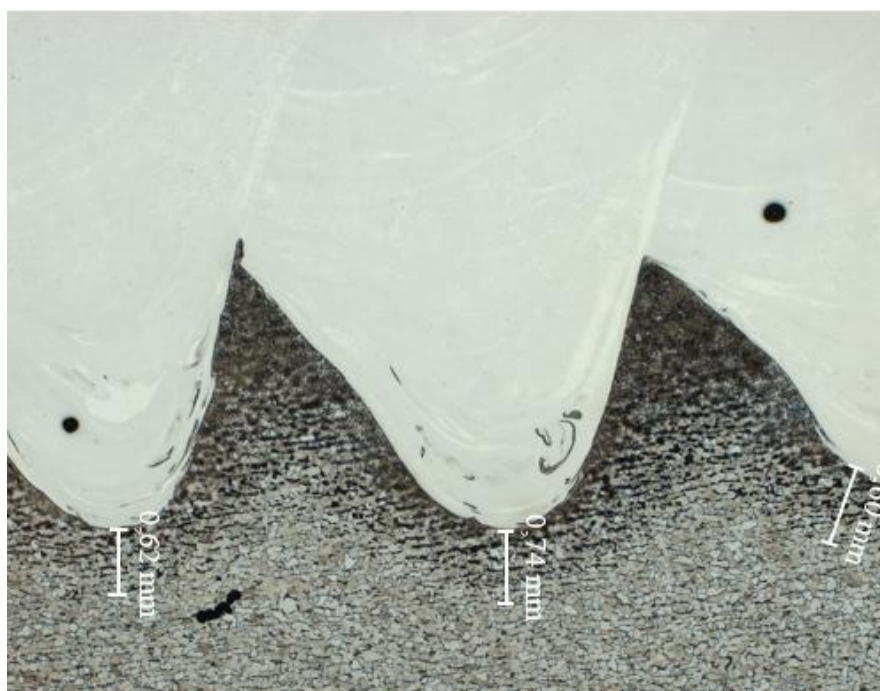
Rys. 8. Pomiary szerokości strefy wpływu ciepła dla próbki 1.
