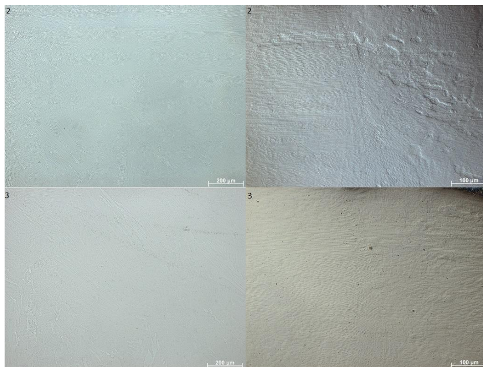
Rys. 15. Struktura napoin próbek 2 i 3, pole jasne, pow. 100x, kontrast Nomarskiego pow. 200x.
