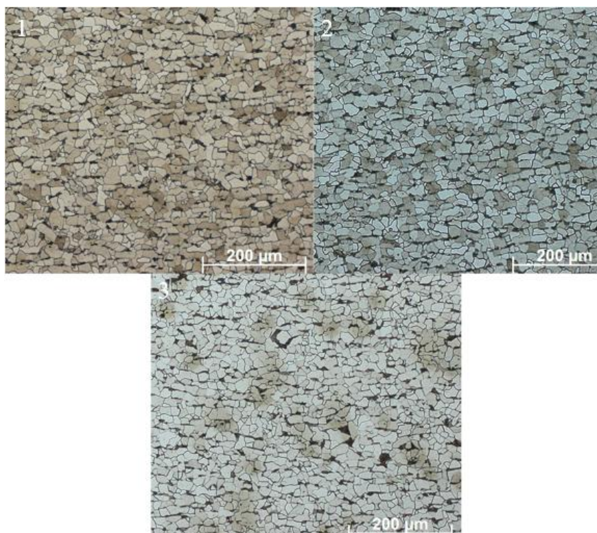
Rys. 11. Struktura materiału podstawowego dla próbek 1, 2 i 3, pow. 100x.
