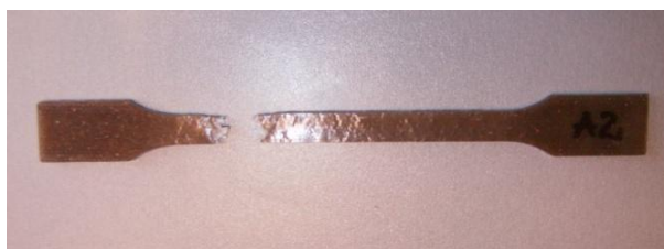
Rys.7. Próbkę po statycznej próbie rozciągania WPC- 10% mączki z łupin orzechów włoskich 500 \mu\text{m} Fig. 7. Sample after static tensile test WPC - 10% walnut shells 500 \mu\text{m}
