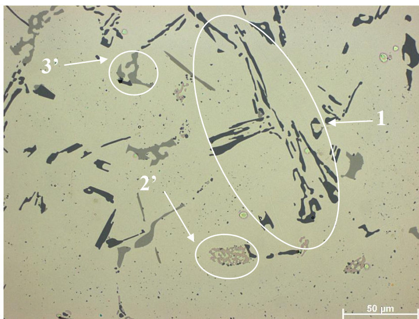
Rysunek 5. Materiał AK64 po 4h przesycaniu, pow. 500x
