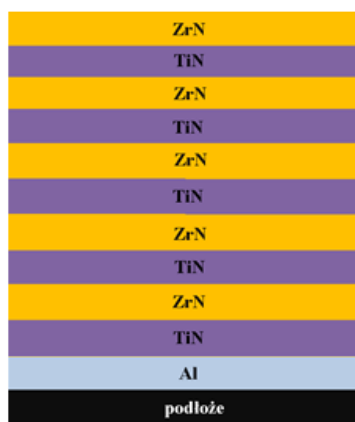
Rys. 1. Schemat powłoki wielowarstwowej \text{Al}(\text{TiN-ZrN})_{\text{x}5} Fig. 1. Multilayer PVD \text{Al}(\text{TiN-ZrN})_{\text{x}5}
