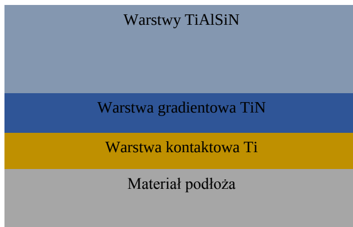
Rys. 2. Podstawowy schemat ułożenia warstw powłoki TiAlSiN [5]
