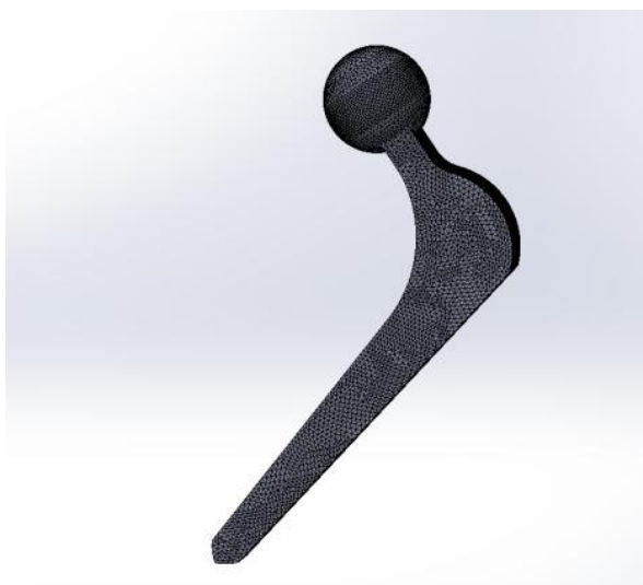
Rysunek 2. Wykonanie siatki bryłowej dla endoprotezy o sile nacisku 600 [N]
