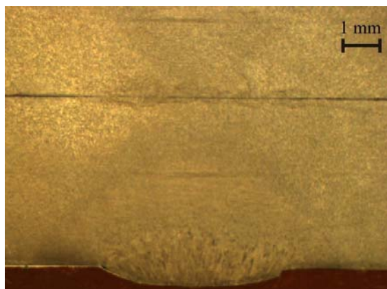
Rys. 10. Struktura stali P355NL1 z wykonaną napoiną
