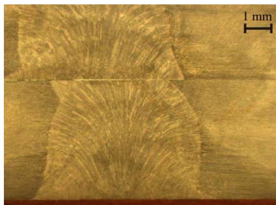
Rys. 4. Struktura stali P460NL2 z wykonanym łączem doczołowym
