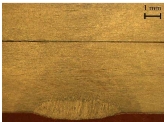
Rys. 6. Struktura stali P460NL2 z wykonaną napoiną
