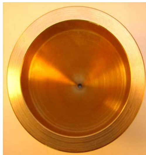
Rysunek 2. Lejek wykorzystywany w metodzie Halla.
