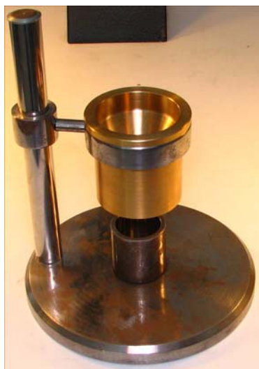
Rysunek 1. Stanowisko do badania własności proszków.
