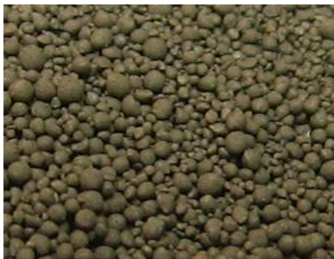
Rysunek 4. Mieszanka proszku węgla WC i kobaltu typu B65 w postaci granulatu
