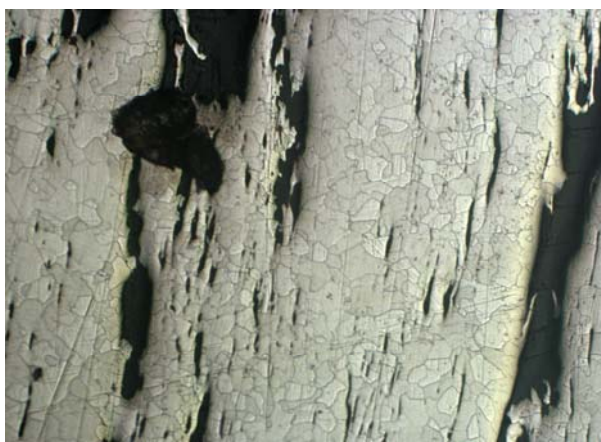
Rysunek 1. Przekrój poprzeczny gwoźdźdza z widocznymi licznymi wtrąceniami w osnowie ferrytu, zgląd trawiony nitalem, mikroskop świetlny, pow. x 500
