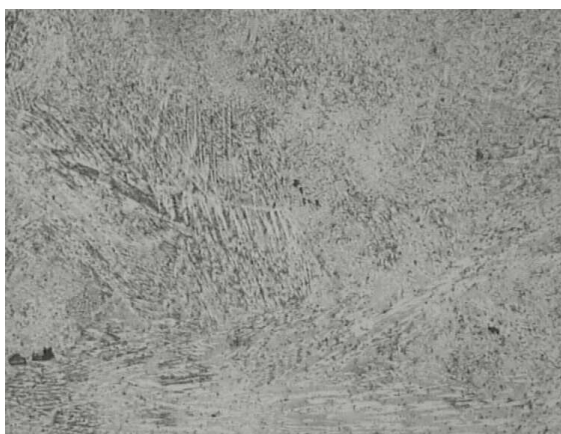
Rys. 7. Obraz struktury stopu \text{Fe}_{43}\text{Co}_7\text{Cr}_{15}\text{Mo}_{14}\text{C}_{15}\text{B}_6 w postaci pręta o średnicy 1,5 [mm], powiększenie 200x
