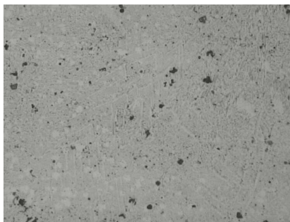
Rys. 8. Obraz struktury stopu \text{Fe}_{41}\text{Co}_7\text{Cr}_{15}\text{Mo}_{14}\text{C}_{15}\text{B}_6\text{Y}_2 w postaci pręta o średnicy 1,5 [mm], powiększenie 200x
