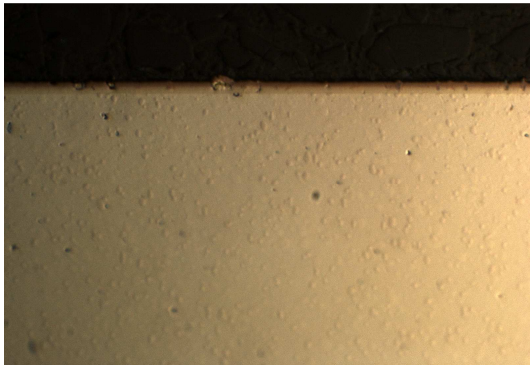
Rys. 2. Stal HS 6-5-2 + WC z naniesioną powłoką TiAlN przy powiększeniu 1250x
