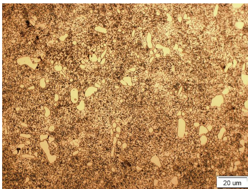
Rys. 1. Stal NC10 wyżarzona zmiękczająco: sferoidyt, węgliki pierwotne oraz drugorzędowe
