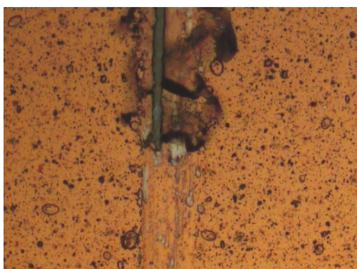
Rys.10. Ślad wgniecenia na powłoce Ti(B,N) naniesionej na podłoże polerowane z ceramiki sialonowej przy obciążeniu a) F_n=5\text{N} , b) F_n=28\text{N} , pow. 100x
