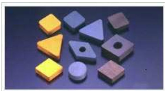
Rys. 1. Płytki skrawające wykonane z ceramiki sialonowej [14]
