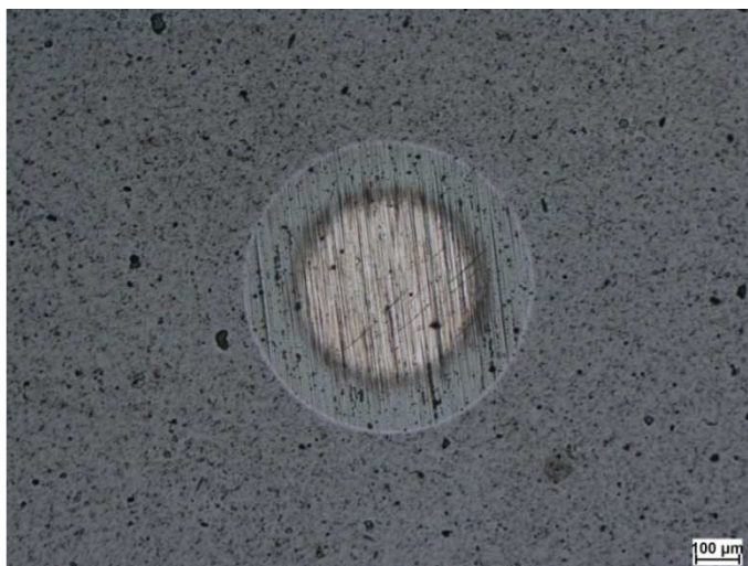
Rys. 1. Charakterystyczny krater powstały w czasie badania grubości powłok metodą „kalotest” na powierzchni powłoki CrAlSiN
