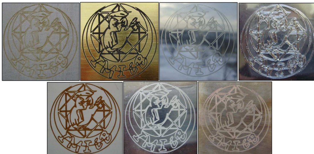
Rysunek 7. Próbki po znakowaniu laserowym.
