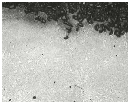
Rysunek 7. Warstwa wierzchnia stopu magnezu MgAl12Zn1 po stopowaniu proszkiem SiC, moc lasera 1,2 kW; prędkości stopowania 0,5 m/min. Powiększenie 50x.
