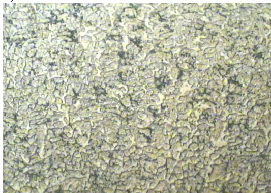
Rysunek 4. Struktura ściegu przetopienia stali na przekroju poprzecznym próbki stali 32CrMoV12-28 z użyciem cząstek węgla niobu NbC, a) strefy w warstwie wierzchniej b), węgliki w strefie przetopionej, c) struktura dendrytyczna na granicy fazy stałej i materiału przetopionego d) struktura dendrytyczna w strefie przetopionej
