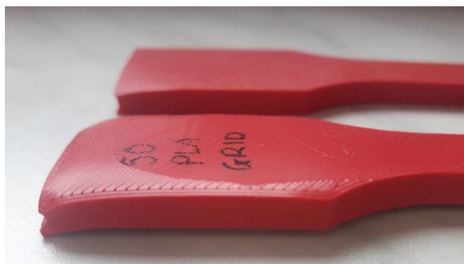
Rysunek 7. Podwinięty koniec próbki 50% Grid Figure 7. Curled end of 50% Grid sample
