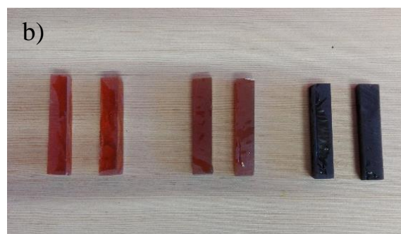
Rysunek 2.2. Zdjęcia wytworzonych próbek a) kompozyty polimerowe wzmocnione tytanowym rusztowaniem, b) próbki z żywicy poliestrowej wzmocnione proszkami metali Figure 2.2. Photos of manufactured samples a) polymer composites reinforced with scaffolds, b) sample of polyester resin reinforced with metal powders
