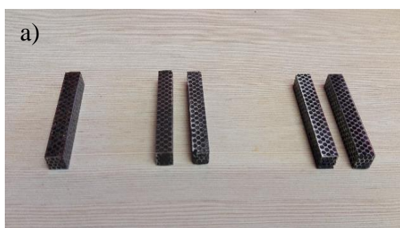
Rysunek 2.2. Zdjęcia wytworzonych próbek a) kompozyty polimerowe wzmocnione tytanowym rusztowaniem, b) próbki z żywicy poliestrowej wzmocnione proszkami metali Figure 2.2. Photos of manufactured samples a) polymer composites reinforced with scaffolds, b) sample of polyester resin reinforced with metal powders
